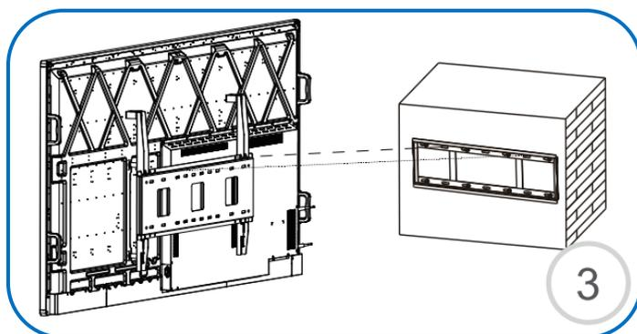
Una vez que el soporte de pared está instalado y fijado correctamente, puede colgar la pantalla táctil. Puede ajustar la posición izquierda y derecha una vez que la pantalla esté colocada.
