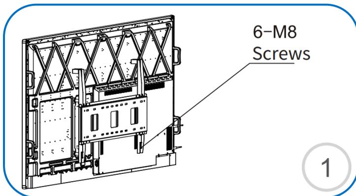
Se utilizan seis tornillos M8 correspondientes al tamaño de los orificios VESA para bloquear las dos barras verticales colgantes en los orificios de montaje VESA de la placa posterior de la pantalla táctil.
